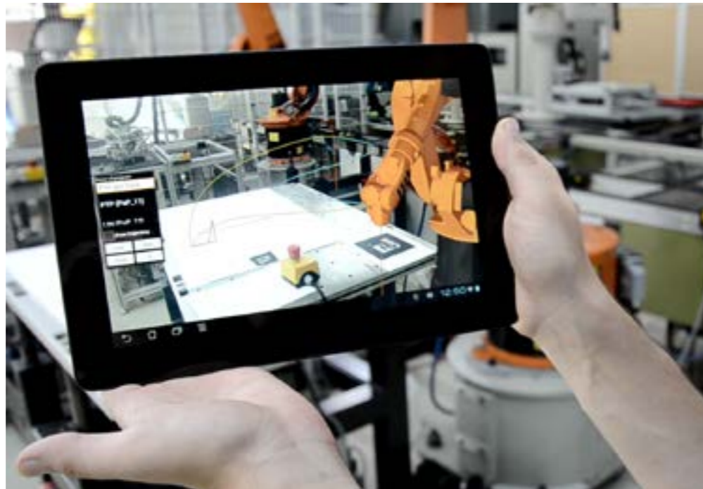
Roboterprogrammierung und Bahnmanipulation mittels Augmented Reality (© IWF, Jens Lambrecht)
