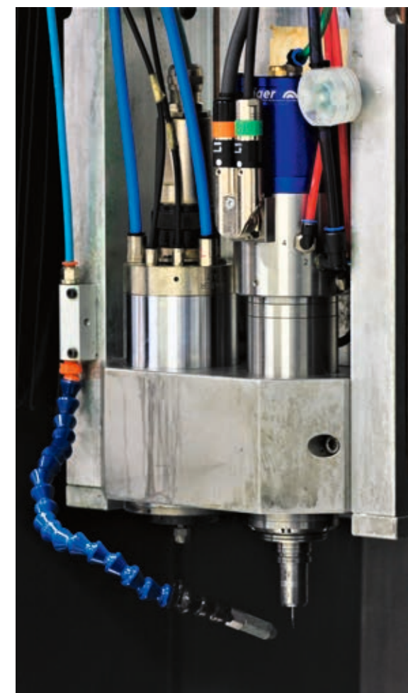
Jäger-Schnellfrequenzspindel Z-Line in der 3-Achs-Hochpräzisionsfräsmaschine WISSNER GAMMA 303 HIGH PERFORMANCE
