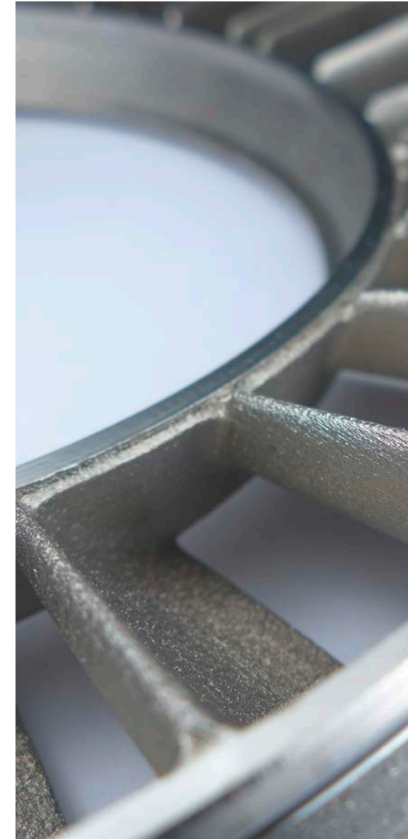
Detail eines additiv gefertigten Schaufelrads aus In718
