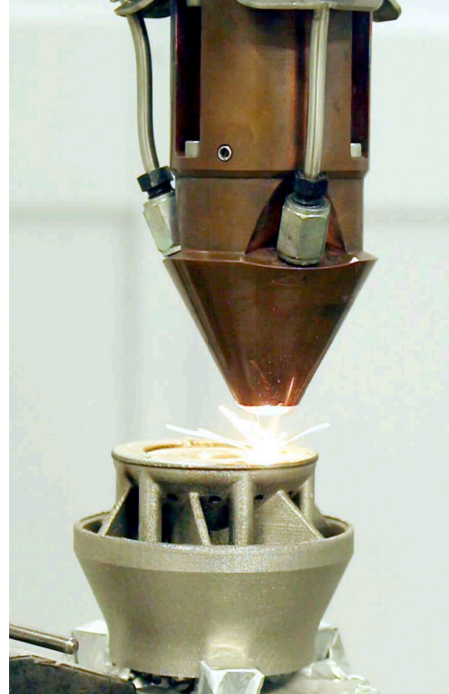
LPA-Materialauftrag auf einen SLM-gefertigten Gasturbinenbrenner
