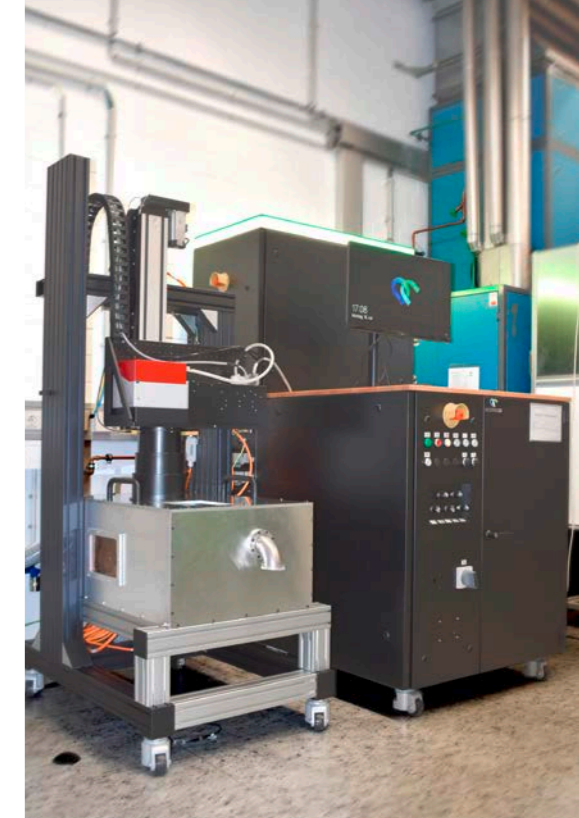
Modulare SLM-Anlage mit Prozesskammereigenbau
