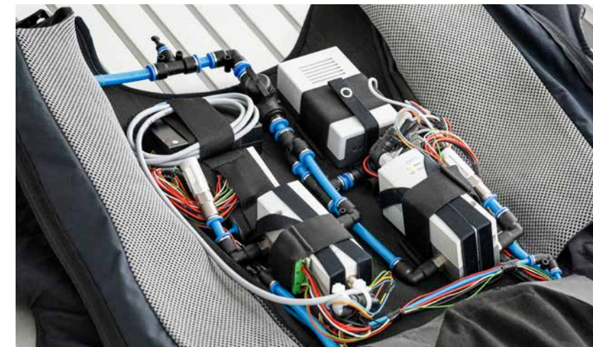
Bilder: 2 Im Rückenmodul finden sich Ventile und Steuerungstechnik für die Kraftunterstützung. 3 Die Druckluftflasche ist schnell gewechselt: Das Nachfüllen dauert etwa eine Minute.
