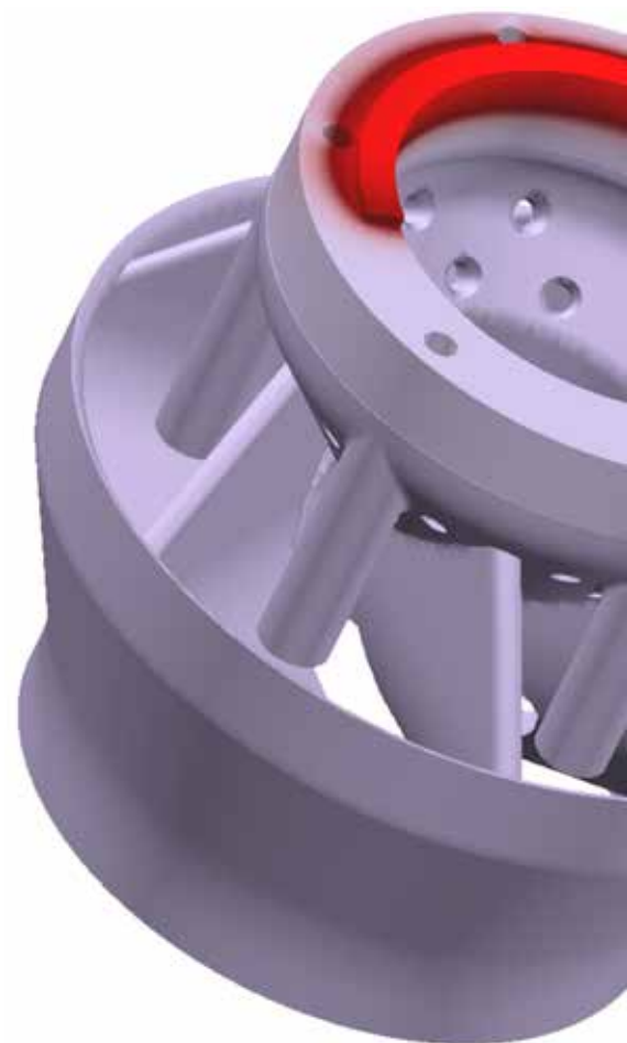
Simulation des Materialauftrages auf einen Brenner
