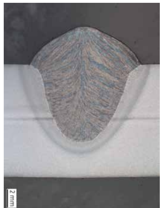
Nicht optimierte UP-Schweißung (oben), optimierte »kehlförmige« UP-Schweißung, erhöhte negative Amplitude des Schweißstroms (unten)
