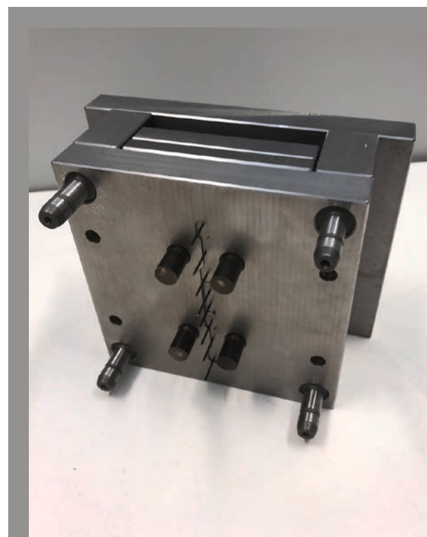
Spritzgusswerkzeug für die Replikation der Probekörper im Forschungsprojekt PhabioApp
