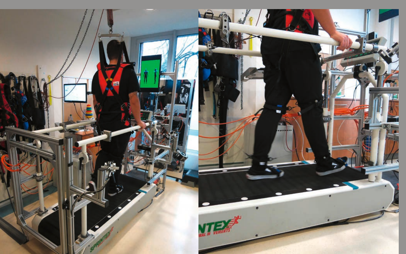
Leichtbau-Robotersystem für die Gangrehabilitation mit Seilkinematik-Laufband und 3D-Kamera-basiertem Biofeedback in der klinischen Erprobung mit Schlaganfallpatienten
