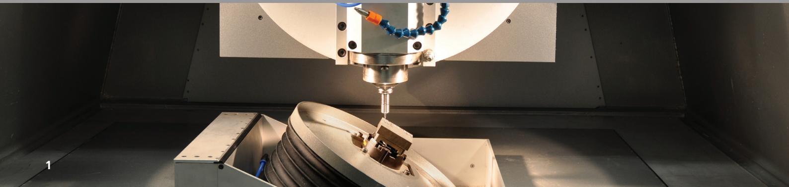
1 Arbeitsraum des Bearbeitungszentrums, Fräsbearbeitung eines Formeinsatzes
