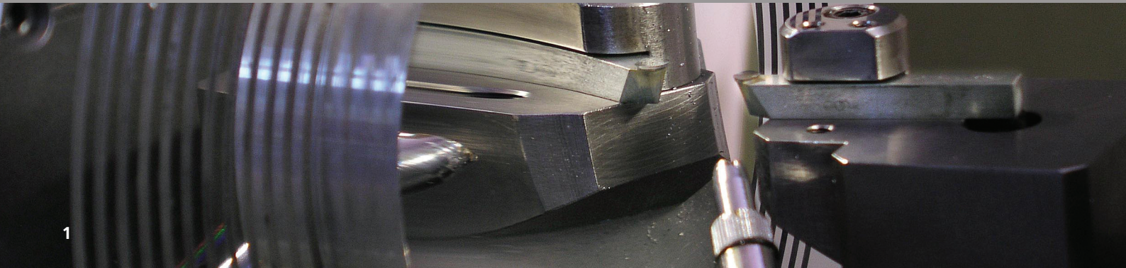
1 UP Drehen eines asphärischen Spiegels in Aluminium mit D=125\text{ mm}
