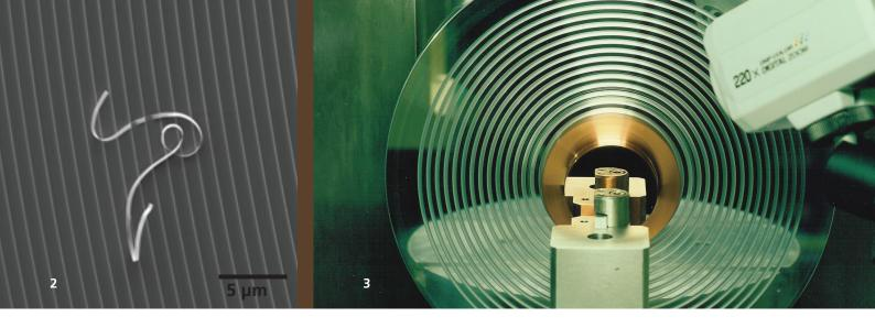
Zur Analyse der Prozesse und der Bearbeitungsergebnisse stehen am IPK neben den klassischen Methoden der taktilen und optischen Oberflächenanalyse sowie der Mikrohärtemessung auch modernste Verfahren der Metallographie zur Verfügung. Für die Oberflächenbeschreibung und –analyse werden darüber hinaus Prinzipien der Mikromesstechnik, wie die konfokale Laser Scanning Mikroskopie und die Weißlichtinterferometrie, eingesetzt.
